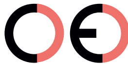
Marca CE falsa (demasiado separados)
